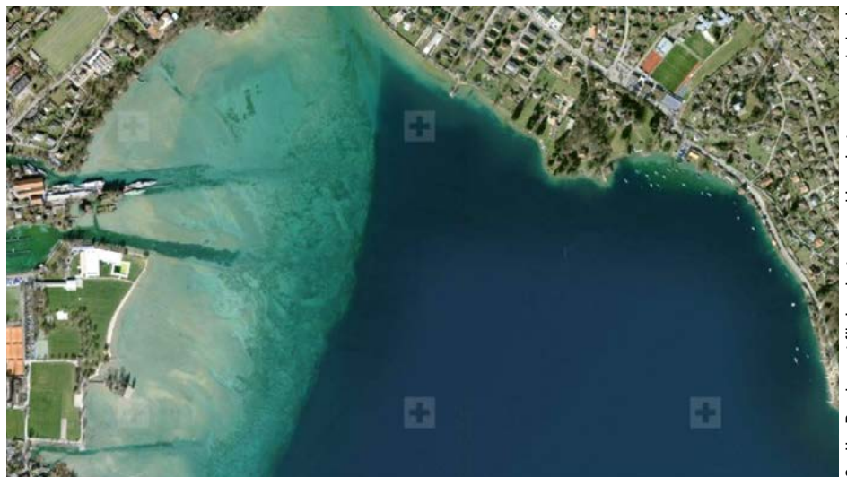
Wasserzeichen (feine Kreuze) als Kopierschutz bzw. Herkunftsvermerk auf einer Orthophoto.
